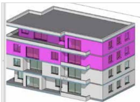
Auf dieser Basis erzeugt Elitecad automatisch ein 3D-Modell des Baukörpers, dessen Position auf dem Grundstück durch Angabe der Abstände zur Grundstücksgrenze noch präzisiert werden muss.
