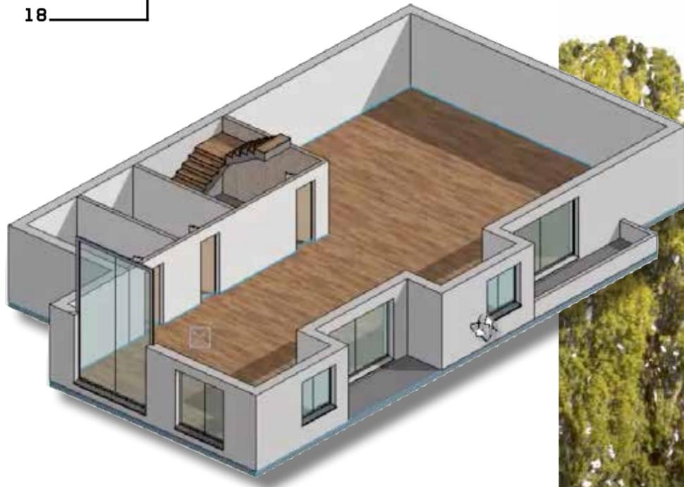
Nach Auswahl der Materialien, etwa für Wände, Böden oder Türen, stellt Elitecad diese bereits in allen Standardansichten, wie zum Beispiel in diesem Schnitt durch ein einzelnes Geschoss, dar
